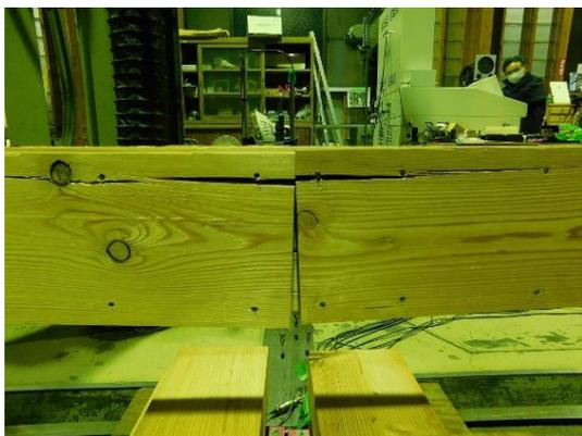
No. 3: 曲げ破壊、最外層釘接合部のせん断破壊
