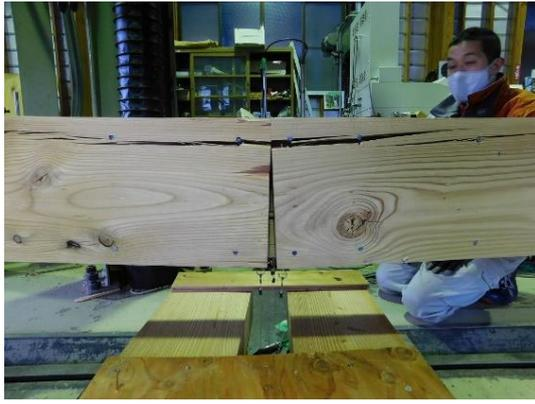
No. 1: 曲げ破壊、最外層釘接合部のせん断破壊
