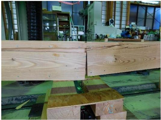
No. 2: 曲げ破壊、最外層釘接合部のせん断破壊
