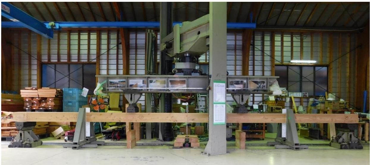
写真 1-2 実大曲げ試験体設置の様子
