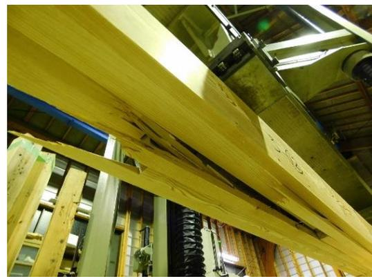
No. 3: 曲げ破壊 (下面)
