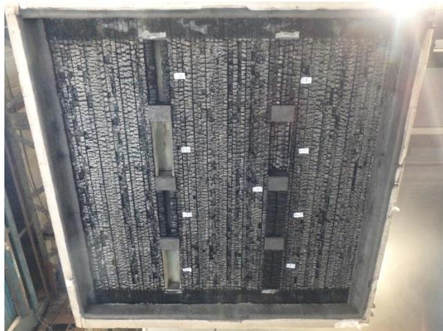
写真2-1-2 試験後の加熱側の状況
