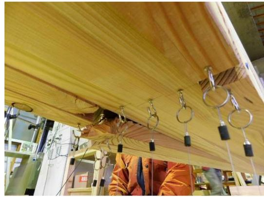
No. 1: 曲げ破壊 (下面)
