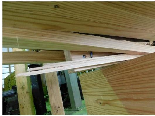
No. 2: 曲げ破壊 (下面)
