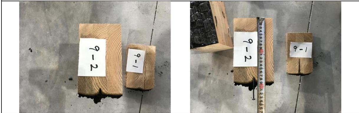
写真2-11 仕様No. 9-2ビス①試験後写真
