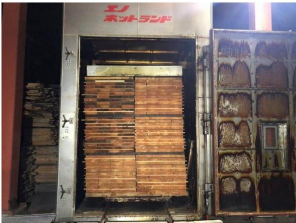
写真-2 カラマツ 210 材等のトラック輸送と人工乾燥の様子
