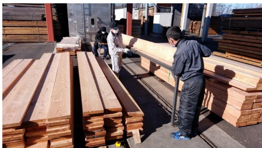
図1 格付け作業の様子
