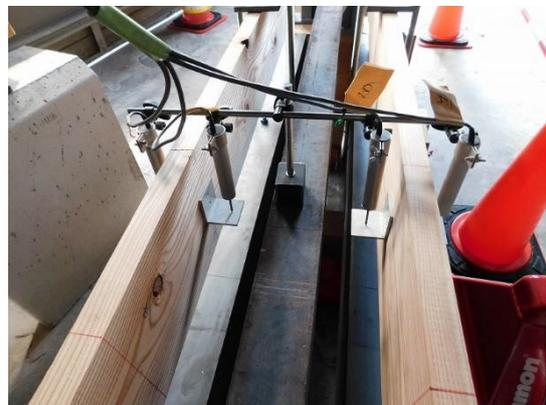
試験体中立軸の両側のたわみの測定
