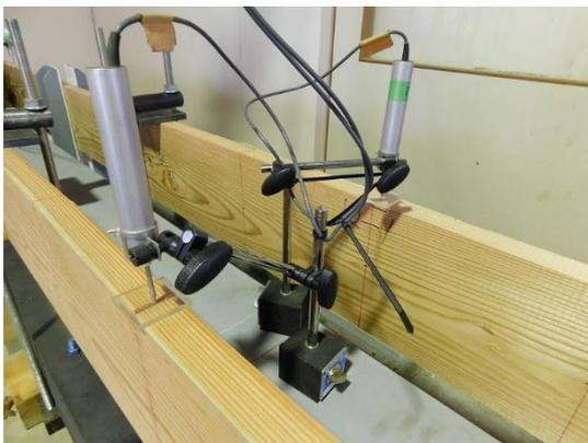
試験体上部でのたわみの測定
