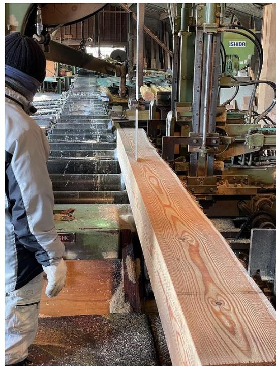
写真-1 カラマツ 210 材の製材の様子
