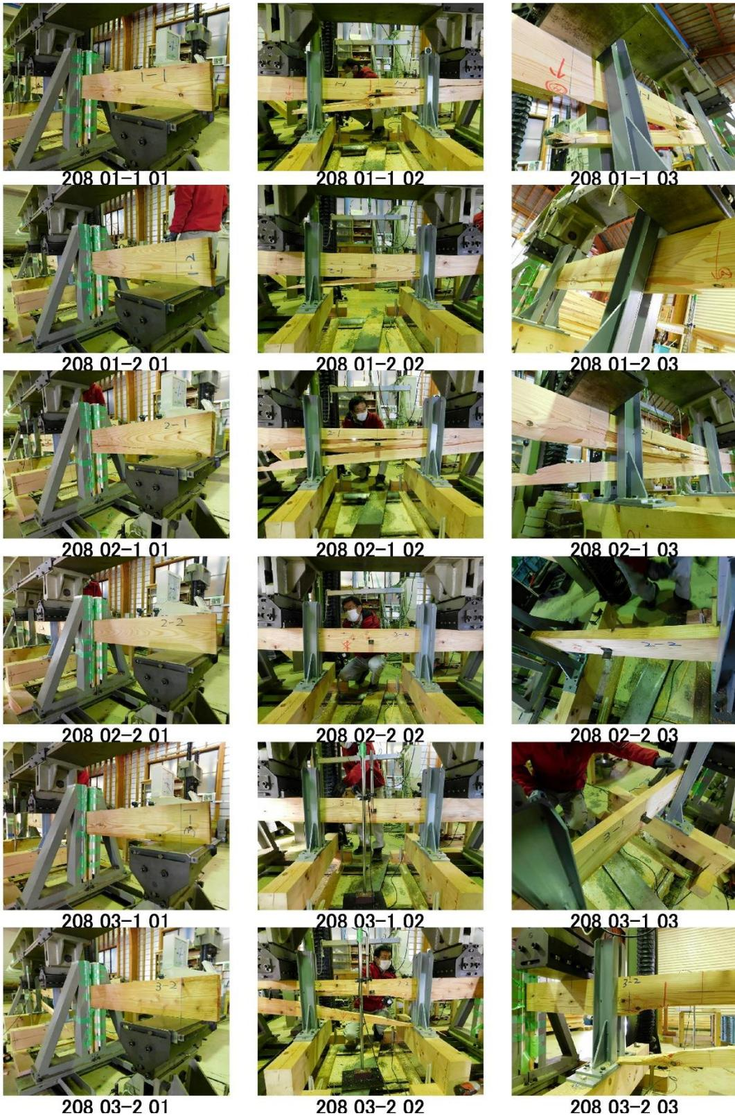
写真 1-10 208 材の曲げ強度試験-1
