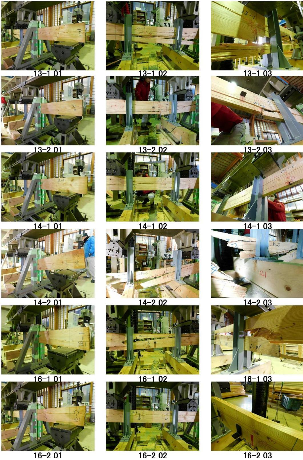
写真 1-7 210 材の曲げ強度試験-4
