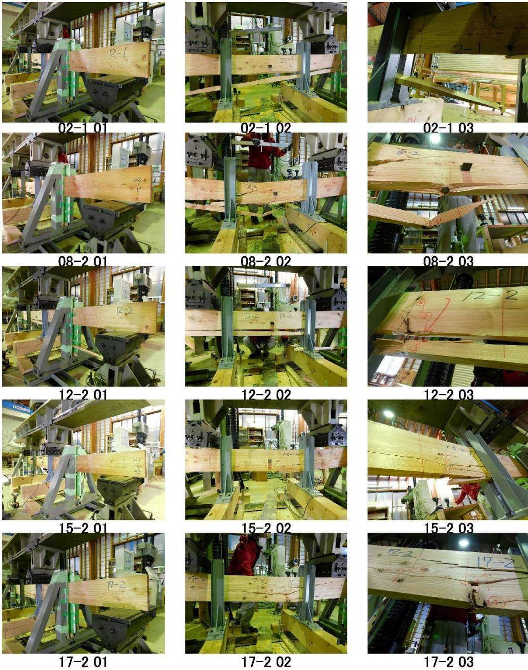
写真 1-9 210 材の曲げ強度試験-6
