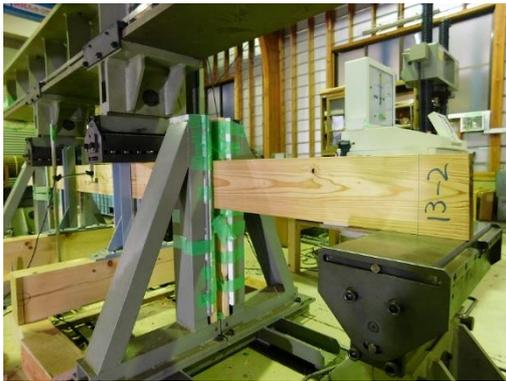
写真 1-1 曲げ強度試験の実施状況
