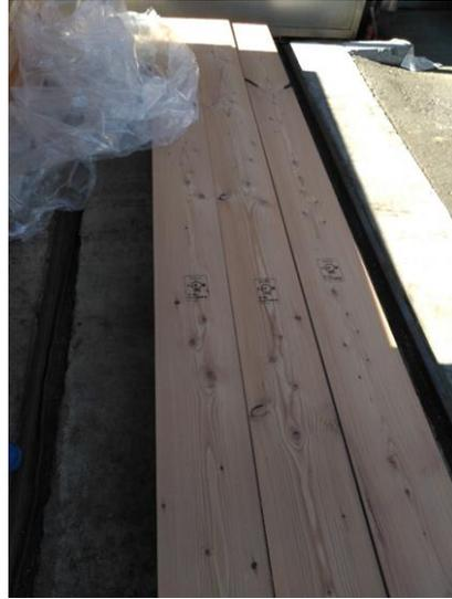
写真 11 一級相当品の印字（材中央に印字）
