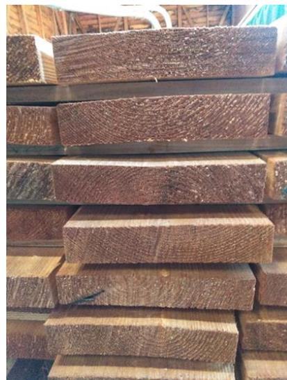
写真6・7 人乾後、プレーナー前の材の木口面
