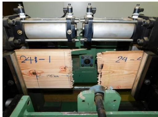
写真 3-4 引張り試験の実施状況
