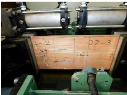
写真 3-5 あて材の引張り破壊の状況
