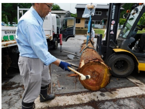
写真 1-4 スギ 4m 丸太供試体と測定状況（根羽村森林組合）
