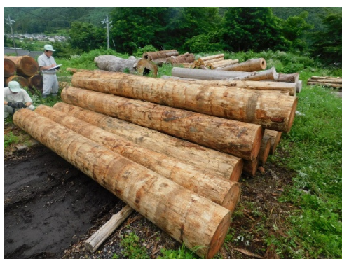
写真 1-1 カラマツ 5m 丸太供試体と測定状況（株青木屋）
