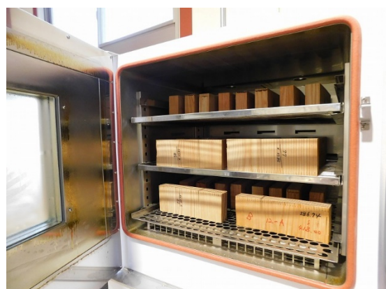
60\pm3^{\circ}\text{C} の恒温乾燥器中18時間以上
