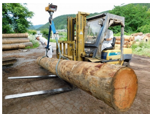
写真 1-1 カラマツ 5m 丸太供試体と測定状況（株青木屋）
