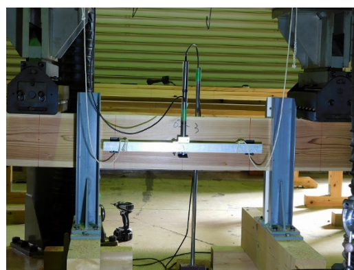
写真 4-3 荷重点間内のたわみの測定
