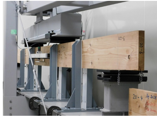
ラテラルサポートの設置
