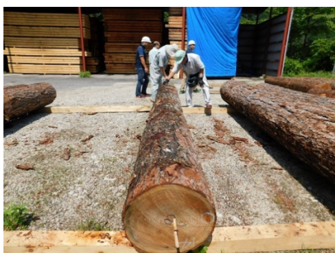
写真 1-3 カラマツ 4m 丸太供試体と測定状況（株勝野木材）
