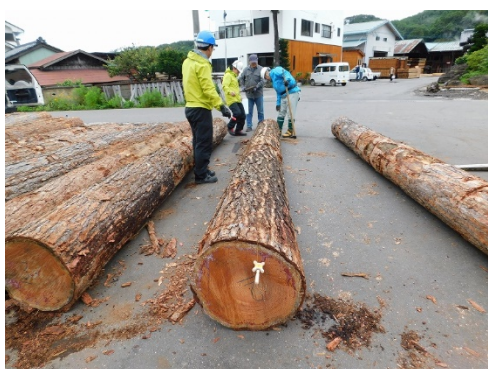
写真 1-1 カラマツ 5m 丸太供試体と測定状況（株青木屋）
