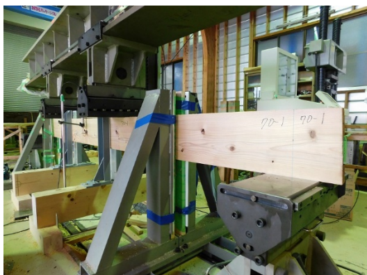
写真 4-1 県南スギ 4m210 材の曲げ強度試験の実施状況
