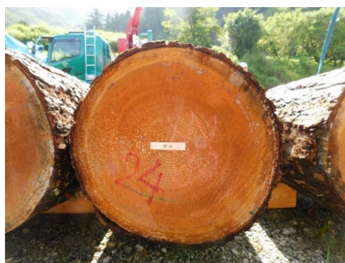
写真 1-3 カラマツ 4m 丸太供試体と測定状況（株勝野木材）
