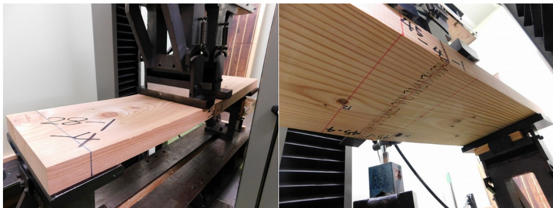
写真 3-2-1 FW 曲げ強度試験の実施状況
