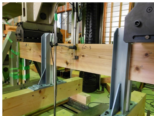
写真 4-1 県南スギ 4m210 材の曲げ強度試験の実施状況
