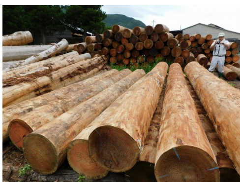
写真 1-2 カラマツ 4m 丸太供試体と測定状況（小林木材株）
