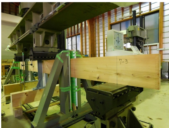
写真 3-1-1 曲げ強度試験の実施状況
