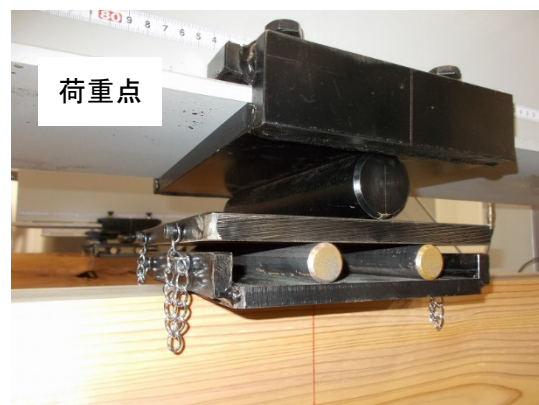
写真 6-2 支点及び荷重点の支持の状況
