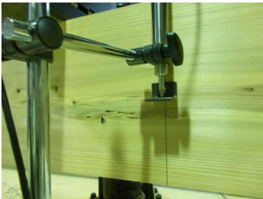
写真 2-7 試験材中央部に設置した変位計
