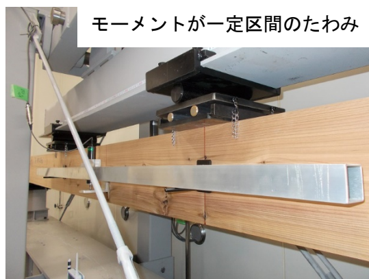
写真 6-3 変位（たわみ）の測定状況
