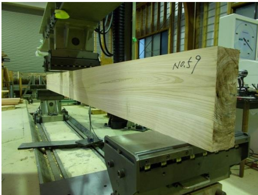
写真 2-5 曲げ試験状況
