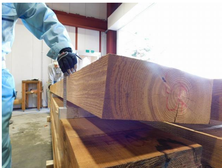
写真 2-9 ねじれの状況
