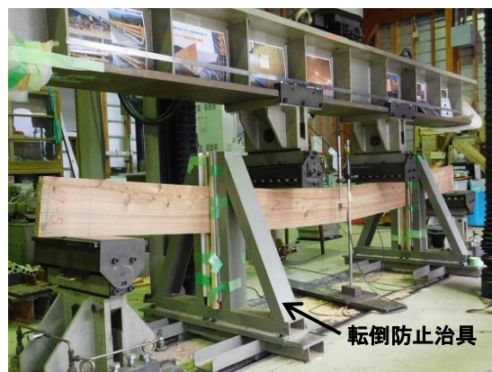
写真 4-3 曲げ試験の様子
