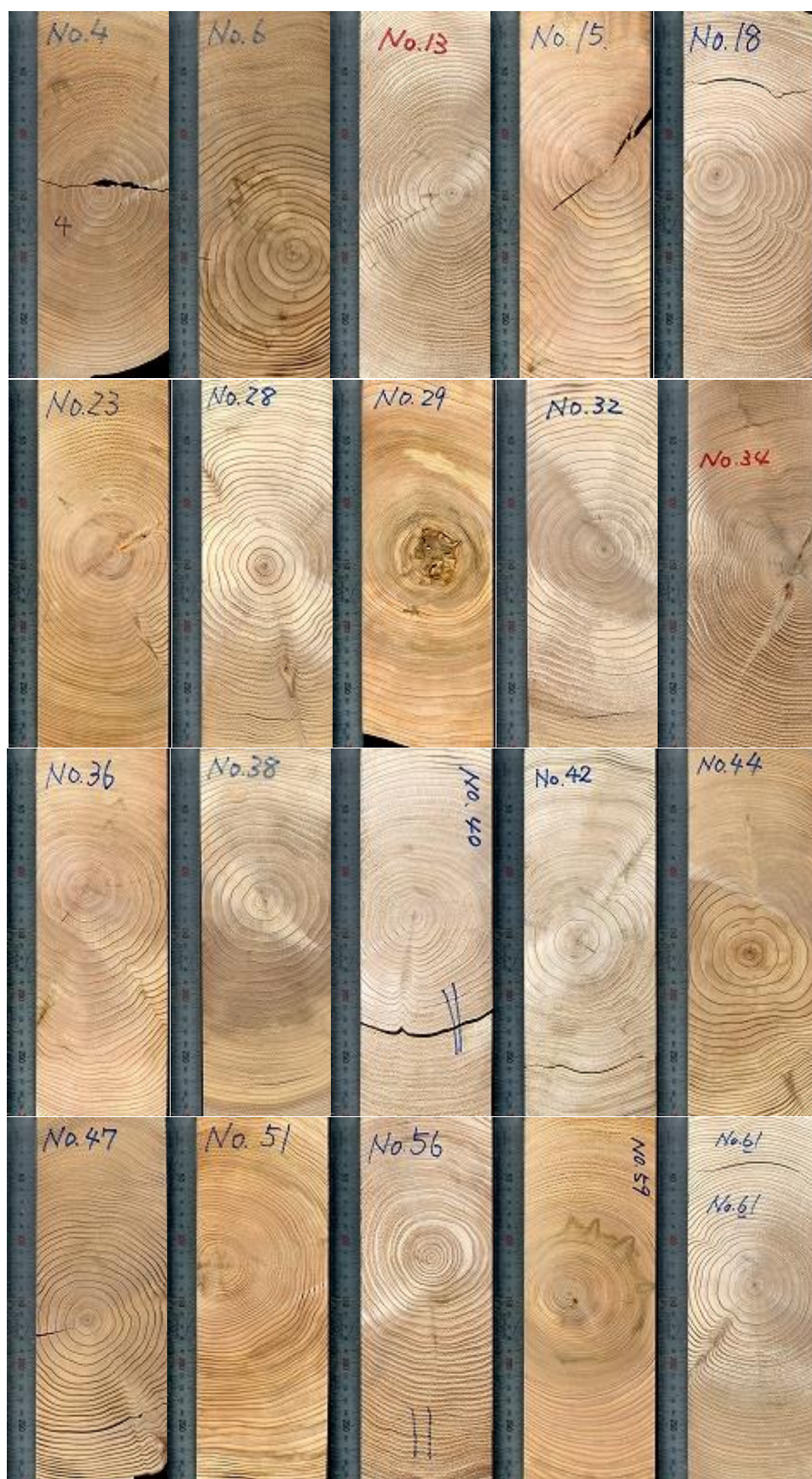
写真 2-19 スギの断面のスキャナー画像
