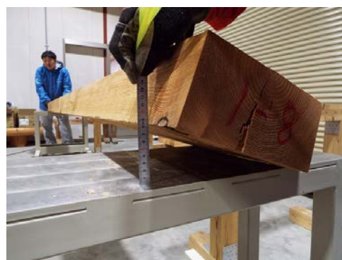
写真 3-12 ねじれの状況 2
