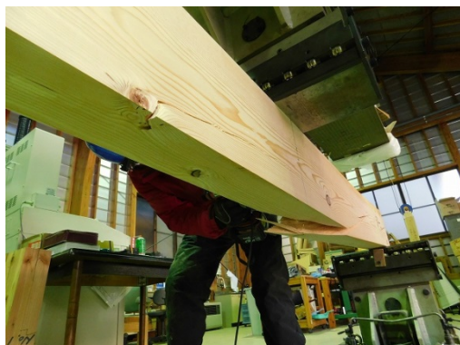
写真 3-15 No. 8-2 の目切れと節による曲げ破壊
