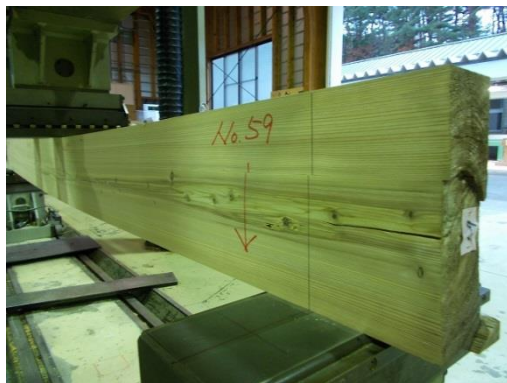
写真 2-16 No. 59 のせん断破壊状況
