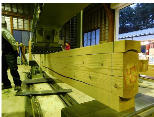
写真 2-12 No. 50 の目まわりとせん断破壊
