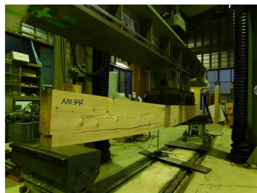
写真 2-11 No. 44 の目まわりとせん断破壊
