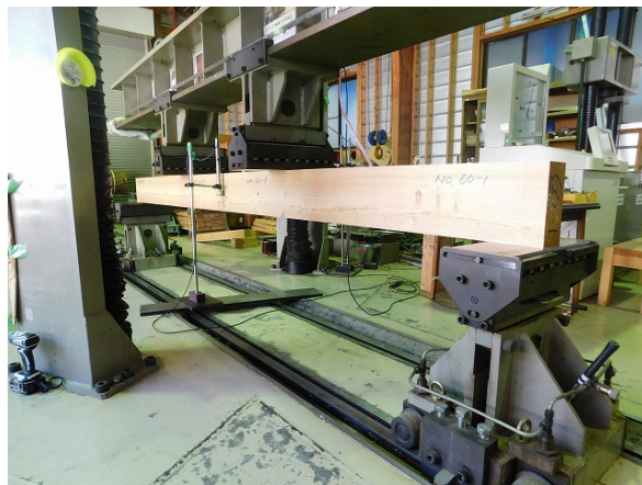
写真 3-7 曲げ試験状況 (スパン中央の全体のたわみを測定)
