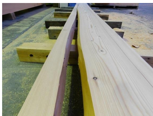
写真 2-13 No. 50 の目まわりとせん断破壊
