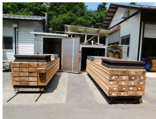
写真 3-6 スギの乾燥前 蒸気式中温乾燥（左） 蒸気圧力併用式中温乾燥（右）
