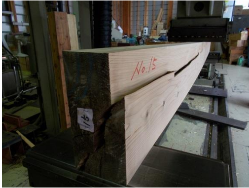
写真 2-14 No. 15 のせん断破壊
