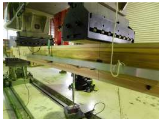
写真 5-7 モーメント一定区間のたわみの測定
