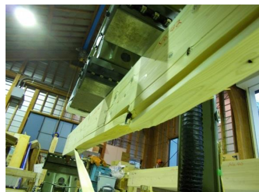
写真 2-17 No. 42 の節からの曲げ破壊状況
