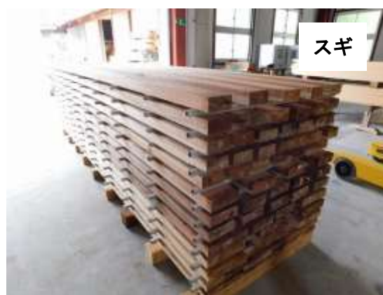
写真5-2 210材木取りからの製材の乾燥
