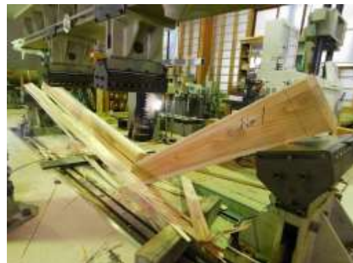
写真 5-5 曲げ強度試験の実施状況
