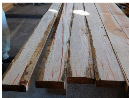
写真 4-10 製材時に既に存在する表面割れ
