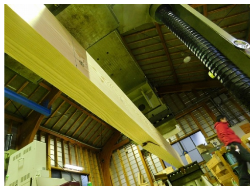
写真 3-14 No. 1-1 の節からの曲げ断破壊
