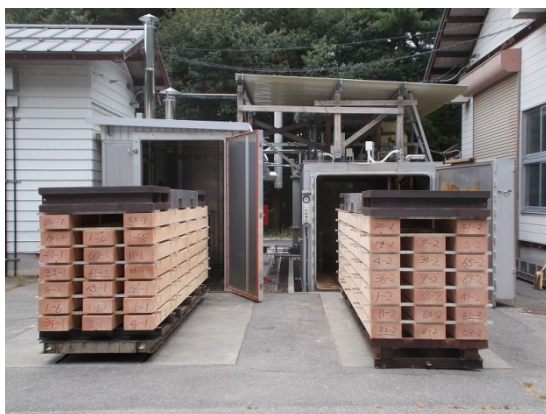
写真 3-5 カラマツの乾燥前 蒸気式中温乾燥（左） 蒸気圧力併用式中温乾燥（右）
