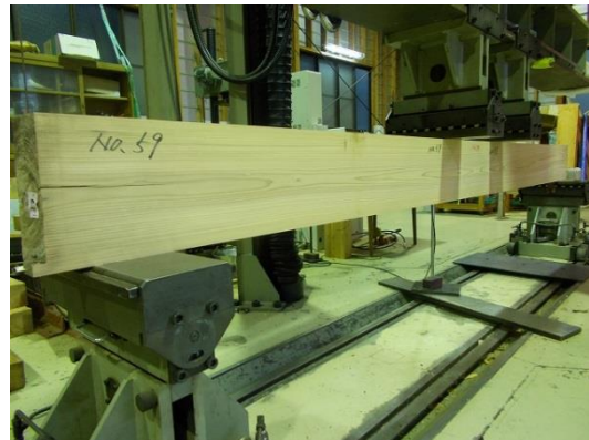
写真 2-6 上部荷重点一下部視点 (1, 650 mm)
