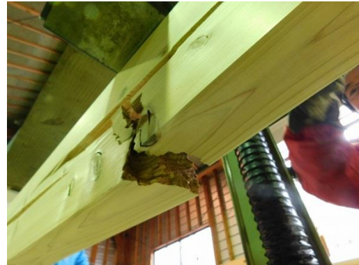
写真 2-15 No. 32 の節からの曲げ破壊
