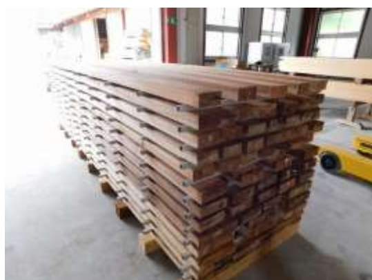
写真5-1 栈積み天然乾燥の実施状況
