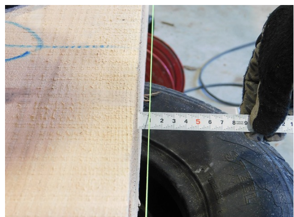
写真 3-10 反り測定状況
