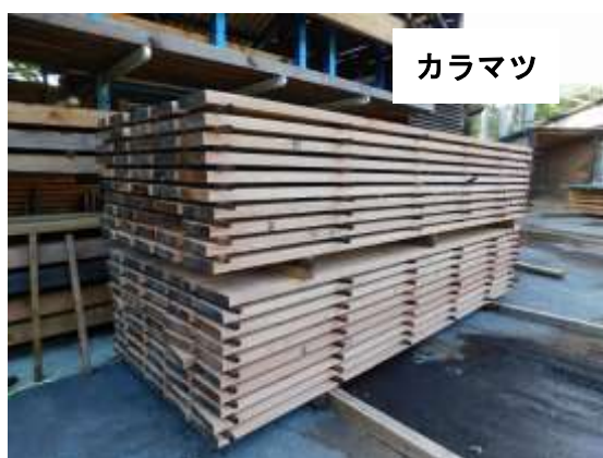
写真5-2 210材木取りからの製材の乾燥
