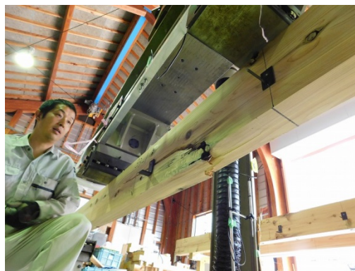
写真 3-18 No. 33-1 の節からの曲げ破壊
