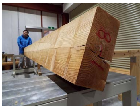
写真 3-11 ねじれの状況 1
