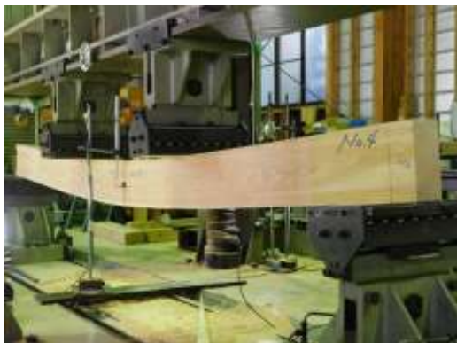
写真 5-5 曲げ強度試験の実施状況
