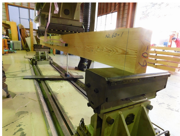
写真 3-8 曲げ試験状況 (荷重点間のたわみを測定)
