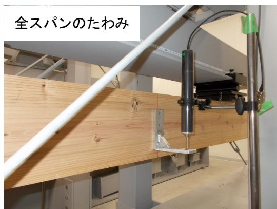
写真 6-3 変位（たわみ）の測定状況
