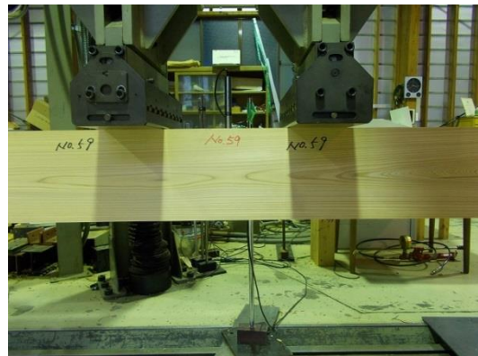
写真 2-8 上部荷重点間 (600 mm)
