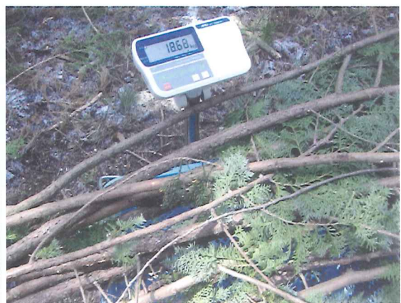
図 6.6 枝葉及び残材の重量計測
