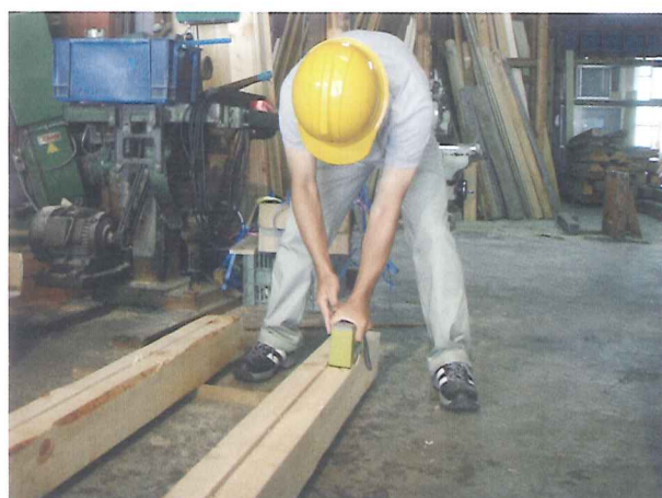
図 6.16 含水率の測定
