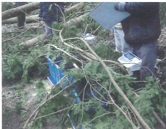
図 6.5 枝葉及び残材の重量計測
