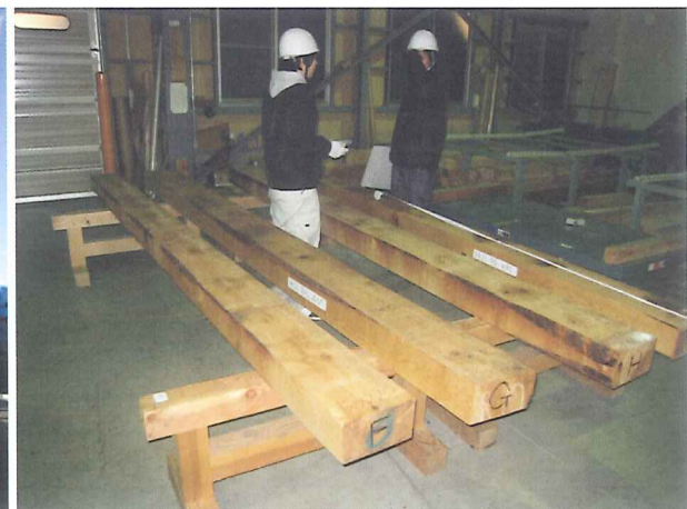
図 5.17 乾燥後製品の計測
