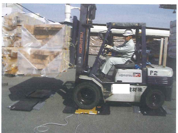
図 5.23 プレカット後の重量計測
