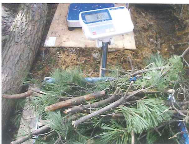
図 5.5 枝葉の重量計測
