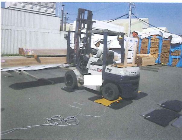
図 5.20 プレカット前の重量計測（後輪）
