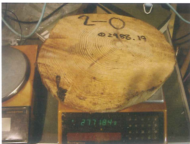
図 5.7 試料の重量計測
