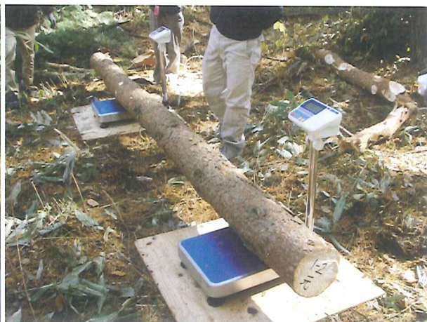
図 5.4 原木の重量計測
