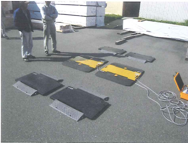
図 5.18 計測に用いたトラック スケール計測機
