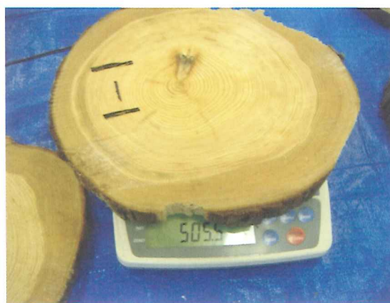
図 6.7 試料の重量計測
