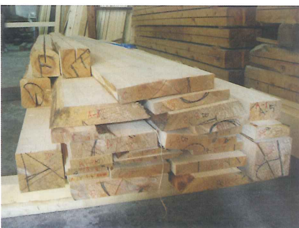
図 6.15 人工乾燥後の製材製品
