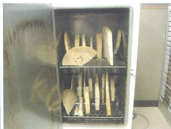
図 6.8 人工乾燥機に試料を入れた状態
