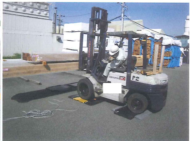
図 5.19 プレカット前の重量計測（前輪）
