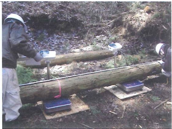
図 6.4 原木の重量計測
