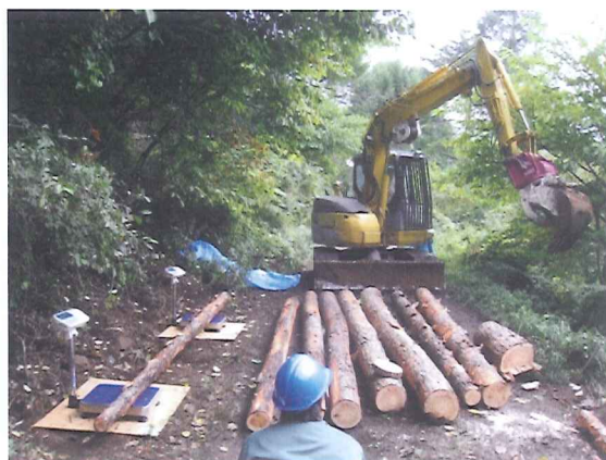
図 4.4 原木の重量計測
