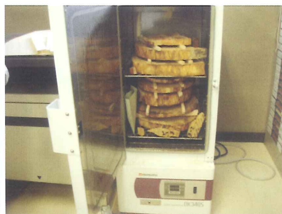
図 4.8 人工乾燥機に試料を入れた状態
