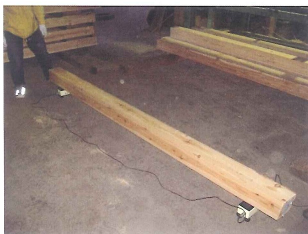
図 4.16 製材後の重量計測
