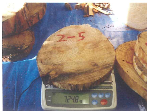
図 4.7 試料の重量計測
