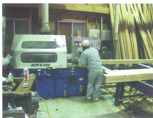
図 4.24 モルダーによる仕上げ工程
