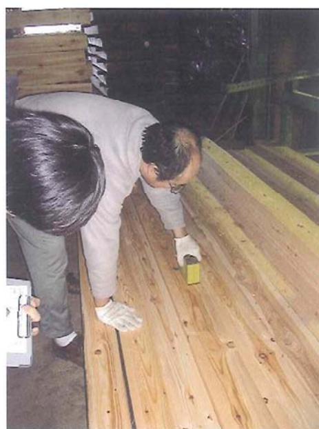
図 4.17 製材後の含水率計測
