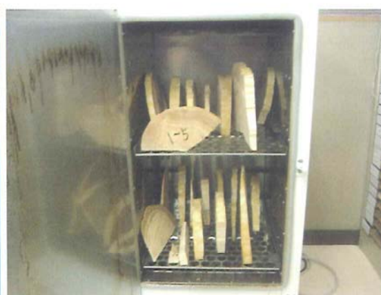
図 6.8 人工乾燥機に試料を入れた状態
