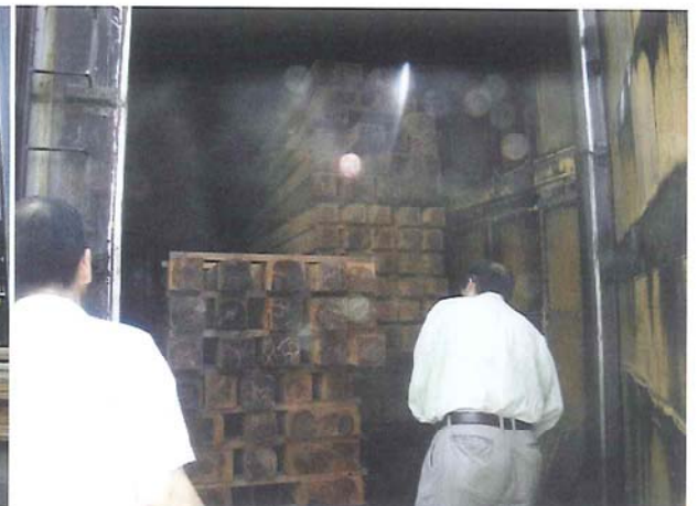
図 3.15 人工乾燥機の内部
