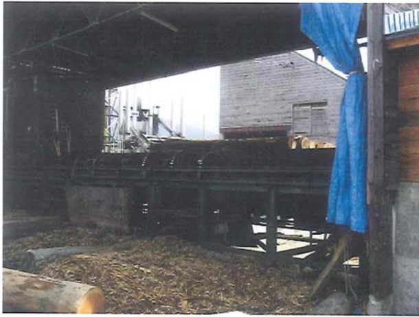
図 3.12 バーカーによる剥皮
