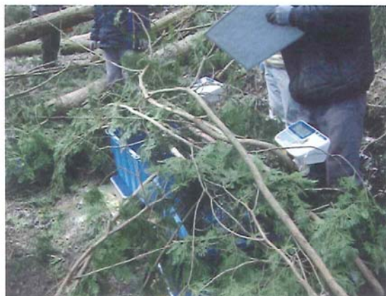
図 6.5 枝葉及び残材の重量計測
