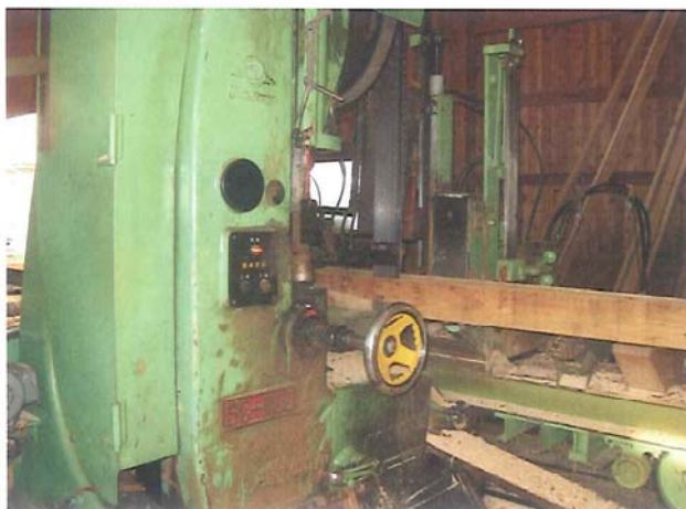
図 4.23 挽き直し工程
