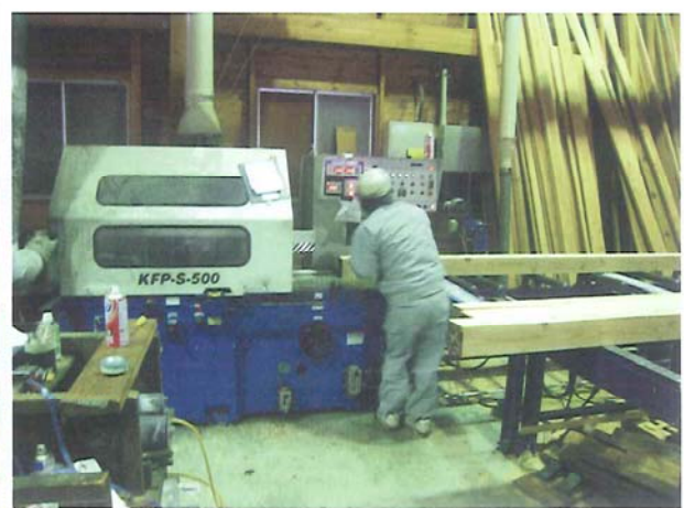
図 4.24 モルダによる仕上げ工程
