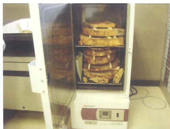
図 4.8 人工乾燥機に試料を入れた状態
