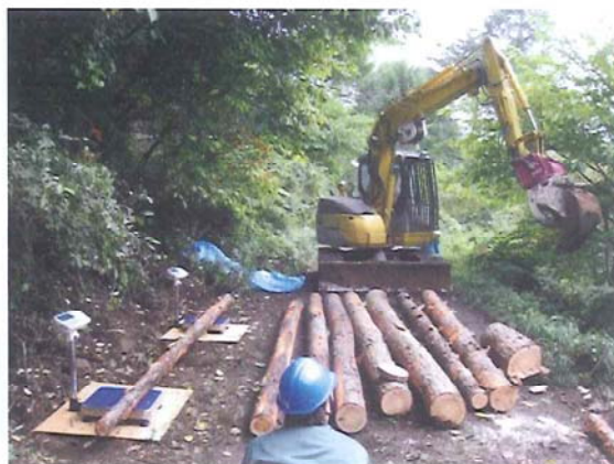
図 4.4 原木の重量計測
