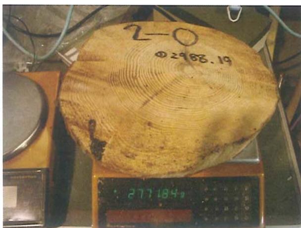
図 5.7 試料の重量計測
