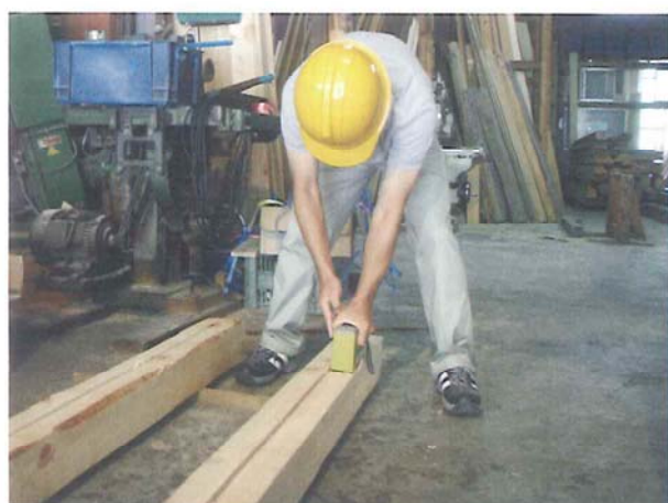
図 6.16 含水率の測定
