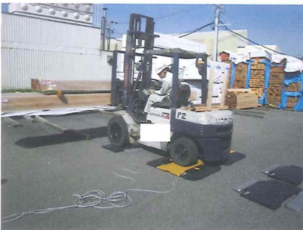
図 5.20 プレカット前の重量計測（後輪）
