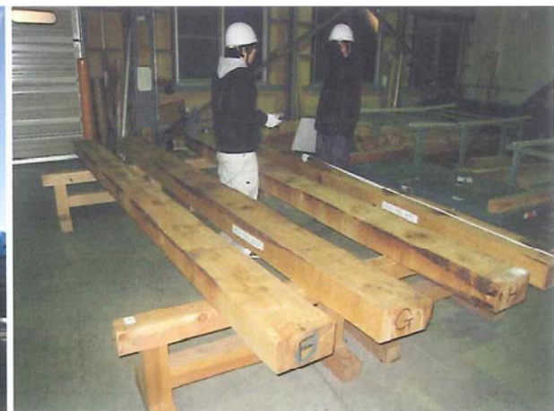
図 5.17 乾燥後製品の計測
