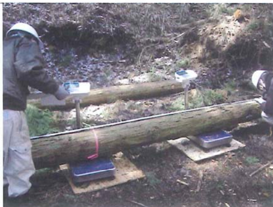
図 6.4 原木の重量計測
