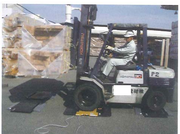
図 5.23 プレカット後の重量計測
