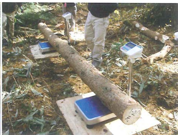
図 5.4 原木の重量計測
