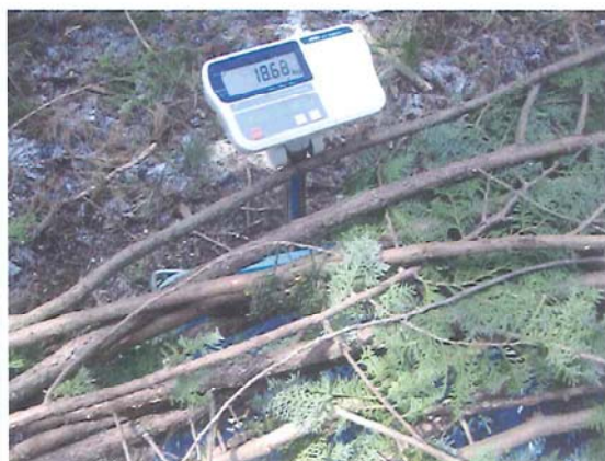
図 6.6 枝葉及び残材の重量計測
