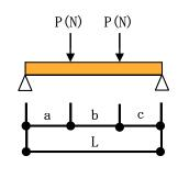
(a=b=c の場合) 曲げモーメント M=PL/3 (N・m) せん断力 Q=P (N) たわみ δ=23PL³/648EI (mm)
