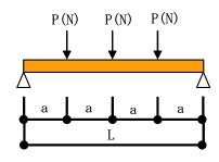
曲げモーメント M=PL/2 (N・m) せん断力 Q=3P/2 (N) たわみ δ=19PL<sup>3</sup>/384EI (mm)
