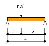
曲げモーメント M=Pab/L (N・m) せん断力 Q=Pb/L (N) たわみ  $\delta$  =Pb ( $L^2$ - $a^2$ )  $^{2/3}$ /9  $\sqrt{3}$ EIeL (mm) (b $\geq$ a)
